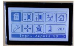
Vous pouvez voir le % d'impression effectué et la température d'extrusion sur l'écran LCD de l'imprimante.
